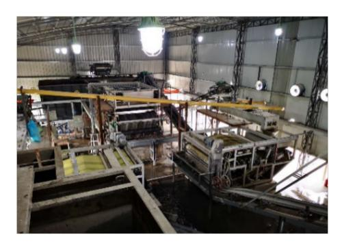
进一步,所述污泥浓缩调理罐3的上端为圆柱体,所述污泥浓缩调理罐3的下端为锥体,且所述锥体的末端为所述污泥浓缩调理罐3的出口。进一步,所述污泥调理剂存储斗5的上端为圆柱体,所述污泥调理剂存储斗5的上端为圆柱体,所述污泥调理剂存储斗5的出口。进一步,所述输送投加装置6为绞龙螺旋输送机。本实用新型一种污泥深度脱水系统的工作过程为:在絮凝剂溶解装置1对絮凝剂进行溶解,将污泥从污泥存储池中抽出,通过絮凝剂投2加管道将絮凝剂溶液投加入污泥进泥管中。新疆小型污泥深度脱水设备研发。安徽贮存污泥深度脱水厂家
